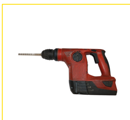
Slagboremaskine (kun til bærende væg af beton/murværk)
