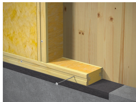
Figur 39: Bagmur af massivtræ (CLT)
